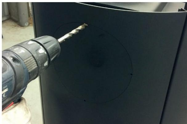
4. Retirer l'opercule de sortie de fumées arrière
